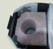
本体内部のパワーストーンと表面外装のソープストーンにより、薪10kgの燃焼で12時間以上の輻射熱を放射しています。
